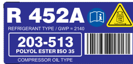
Figur 4. Namnskylt för köldmedium och kompressorolja
