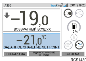
Рис. 13. Изображение стандартного экрана: установка работает в дизельном и непрерывном режиме
