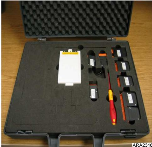
La herramienta cuenta con todos los enchufes de prueba necesarios para realizar todas las pruebas mencionadas anteriormente. El software se encuentra en el sitio web de JCI. [www.myrefcon.com/support/mp-4000-tester/](http://www.myrefcon.com/support/mp-4000-tester/)
