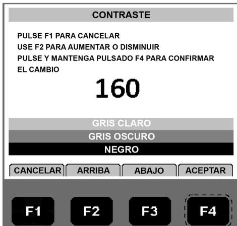
2. Pulse las teclas F2 o F3 ARRIBA/ABAJO para desplazar el valor de contraste hacia arriba o hacia abajo.
