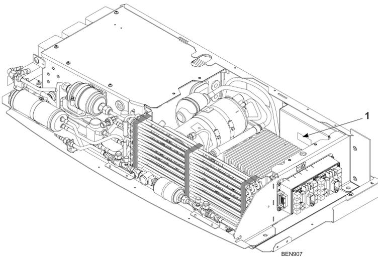
**Abbildung 11. Hermetischer Kompressor, Position der Seriennummer**
