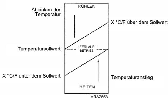
Werkseinstellung für X ist 3 °C (5 °F). Während des Einbaus der Maschine kann der Wert in Schritten von 1 °C/F um 1 bis 5 °C (2 bis 9 °F) angepasst werden.
