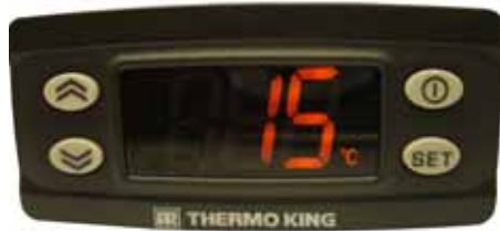
Quadro comandi in cabina
