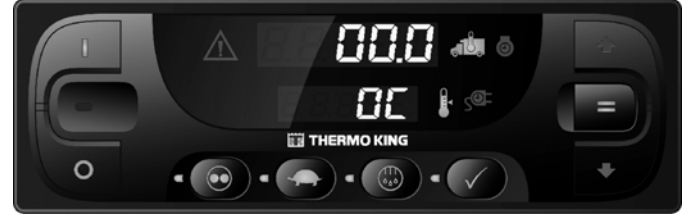
Şekil 6: Standart HMI Kontrol Paneli
