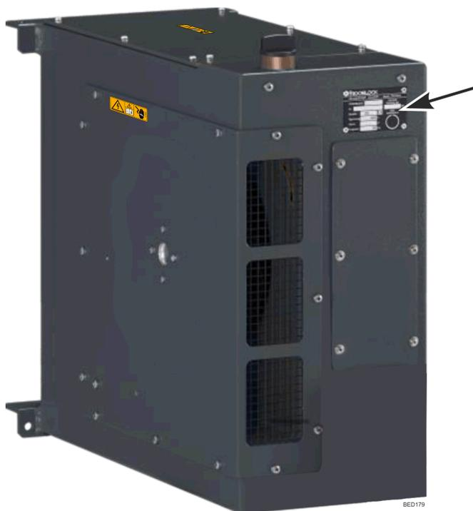
Per la posizione del numero di serie dell'unità di refrigerazione vedere il relativo manuale dell'operatore
