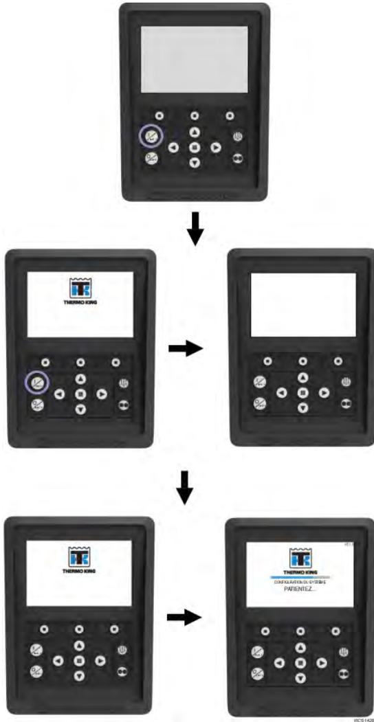
Une fois la séquence de démarrage du système terminée, l'affichage standard apparaîtra et le groupe frigorifique démarrera en mode Thermique (si aucune alimentation électrique n'est détectée).
