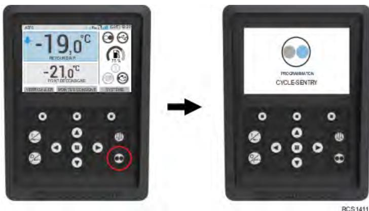
**Figure 22. Illustration du mode Cycle-Sentry**
