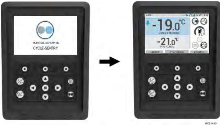
Si se ha producido un error en la iniciación, la unidad volverá al modo continuo. Compruebe si hay alguna alarma y vuelva a intentarlo.
