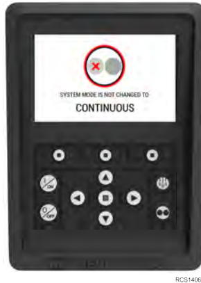
Figur 20. Display for Mislykket drift
