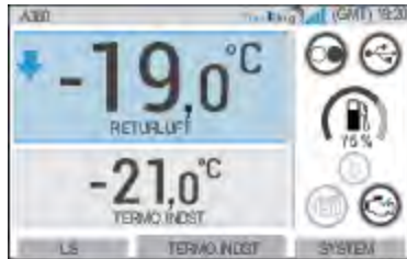
Figur 28. Elmotor-ikon erstattet af viste dieselmotor-ikon
