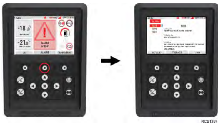
Figur 39. Displayet Alarm aktiv og Alarmoplysninger vist
