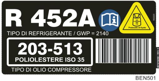
La decalcomania sui gas fluorurati indica che l'apparecchiatura contiene gas fluorurati a effetto serra.
