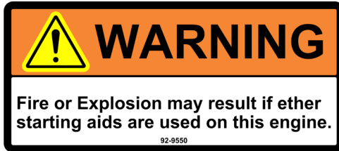
Figur 3. Brug ikke æter som starthjælp (i nærheden af motoren)
