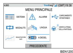
L'unità può passare manualmente in modalità diesel dal MENU PRINCIPALE durante il funzionamento in modalità elettrica.
