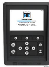
Una volta completata la sequenza di avvio del sistema, viene visualizzato il display standard e l'unità si avvia in modalità diesel (se non viene rilevata la modalità elettrica di riserva).
