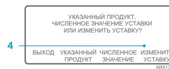
Если параметры для указанного продукта были запрограммированы с использованием диапазона уставок, то уставку для указанного продукта можно изменять. В этом примере показан стандартный экран с экранной кнопкой ПРОДУКТ/УСТАВКА.
