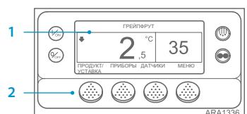
Для выбора или изменения численного значения уставки выполните следующие действия. В этом примере показан стандартный экран с экранной кнопкой ПРОДУКТ/УСТАВКА. Использование стандартного экрана с экранной кнопкой УСТАВКА в целом аналогично, но некоторые экраны немного отличаются.
