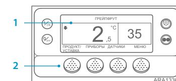
1. Для выбора или изменения численного значения уставки выполните следующие действия. В этом примере показан стандартный экран с экранной кнопкой ПРОДУКТ/УСТАВКА. Использование стандартного экрана с экранной кнопкой УСТАВКА в целом аналогично, но некоторые экраны немного отличаются.
